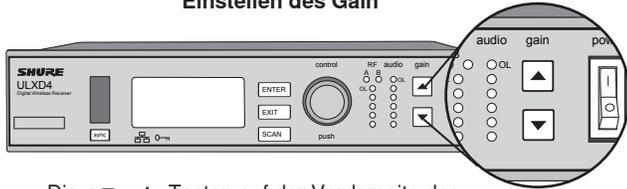
Die ▲ ▼ gain-Tasten auf der Vorderseite des Empfängers drücken, um das Gain schrittweise von -18 bis +42 dB einzustellen.
