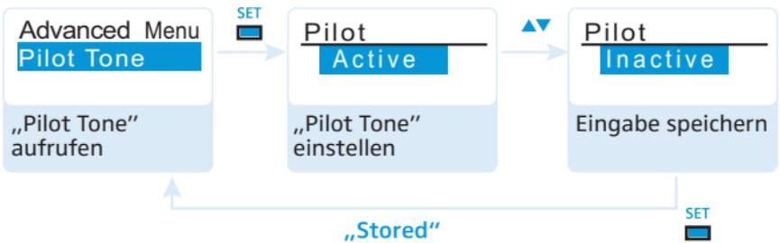
Der Pilotton hat eine nicht hörbare Frequenz, die vom Sender übertragen und vom Empfänger ausgewertet wird. Der Pilotton unterstützt die Rauschsperrfunktion („Squelch“) des Diversity-Empfängers. Dadurch werden Störungen durch Funksignale anderer Geräte vermieden.
