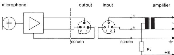
Circuito com transformador de entrada **sem** derivação central (isolado da terra):
