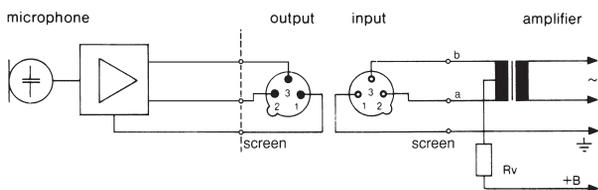
Circuito con transformador de entrada **sin** derivación central (aislado de tierra):
